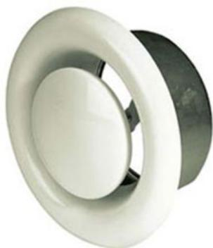
Диффузоры VE...M предназначены для применения в вытяжных системах вентиляции и кондиционирования. Они представляют собой потолочные воздухораспределительные элементы с плавным регулированием расхода воздуха, которое осуществляется с помощью вращения центрального диска. Диффузоры изготавливаются из стали и имеют защитное порошковое покрытие белого цвета. Для удобства монтажа диффузоры снабжены соединительной муфтой, с помощью которой они присоединяются к воздуховодам.
