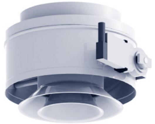
Многоконусные сопловые воздухораспределители SMK...E1 оснащены электроприводом и конструктивно представляют собой корпус с подводным патрубком, внутри которого на подвижной оси расположена центральная вставка, выполненная в виде набора цилиндров с коническим раструбом.
