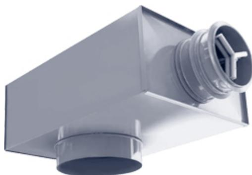
Камеры статического давления PLR предназначены для монтажа потолочных диффузоров с круглыми присоединительными патрубками в системах вентиляции и кондиционирования. Они обеспечивают выравнивание и стабилизацию воздушного потока, поступающего в диффузор, что существенно улучшает условия формирования и аэродинамические характеристики образуемых диффузорами струй.
