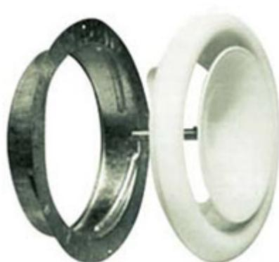
Диффузоры VS...М предназначены для применения в приточных системах вентиляции и кондиционирования. Они представляют собой потолочные воздухораспределительные элементы с плавным регулированием расхода воздуха, которое осуществляется с помощью вращения центрального диска. Диффузоры изготавливаются из стали и имеют защитное порошковое покрытие белого цвета. Для удобства монтажа диффузоры снабжены соединительной муфтой, с помощью которой они присоединяются к воздуховодам.
