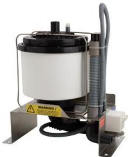
Бескорпусные увлажнители OEM-eSTEAM предназначены для монтажа внутри вентиляционных установок, центральных кондиционеров и прецизионных кондиционеров. Увлажнители могут объединяться в группу до 6 блоков, при этом суммарная производительность достигает 144 кг/час. Контроллер, управляющий работой пароувлажнителя, может быть установлен в любом удобном месте, например, в шкафу управления.
