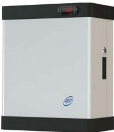
Электродные пароувлажнители eSTEAM предназначены для увлажнения воздуха в системах вентиляции и кондиционирования. Широкий модельный ряд позволяет осуществить точный подбор модели по производительности и обеспечить снижение капитальных затрат. Увлажнители могут объединяться в группу до 6 блоков, при этом суммарная производительность достигает 288 кг/час. Микропроцессорная система управления гарантирует высокую эффективность работы при оптимальном расходе воды и электроэнергии.
