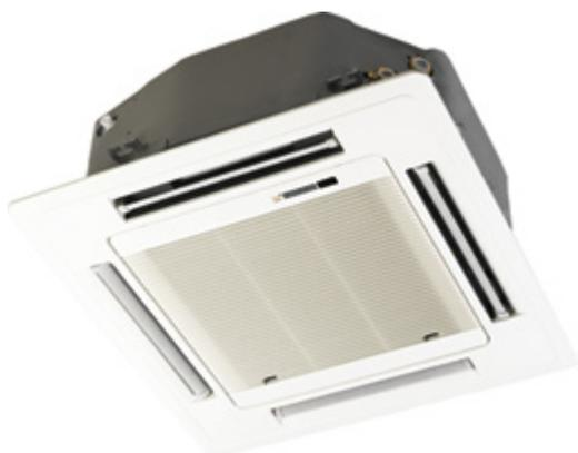
Кассетные фанкойлы COOL-hit модельного ряда СН предназначены для установки в подвесной потолок домашних и офисных помещений. Автоматические жалюзи, расположенные по краям панели, обеспечивают максимально равномерное распределение воздуха, управление режимами работы жалюзи осуществляется с пульта управления. Модельный ряд включает восемь базовых типоразмеров двух- и четырехтрубных фанкойлов холодопроизводительностью от 2 до 10,5 кВт. Модели фанкойлов:
